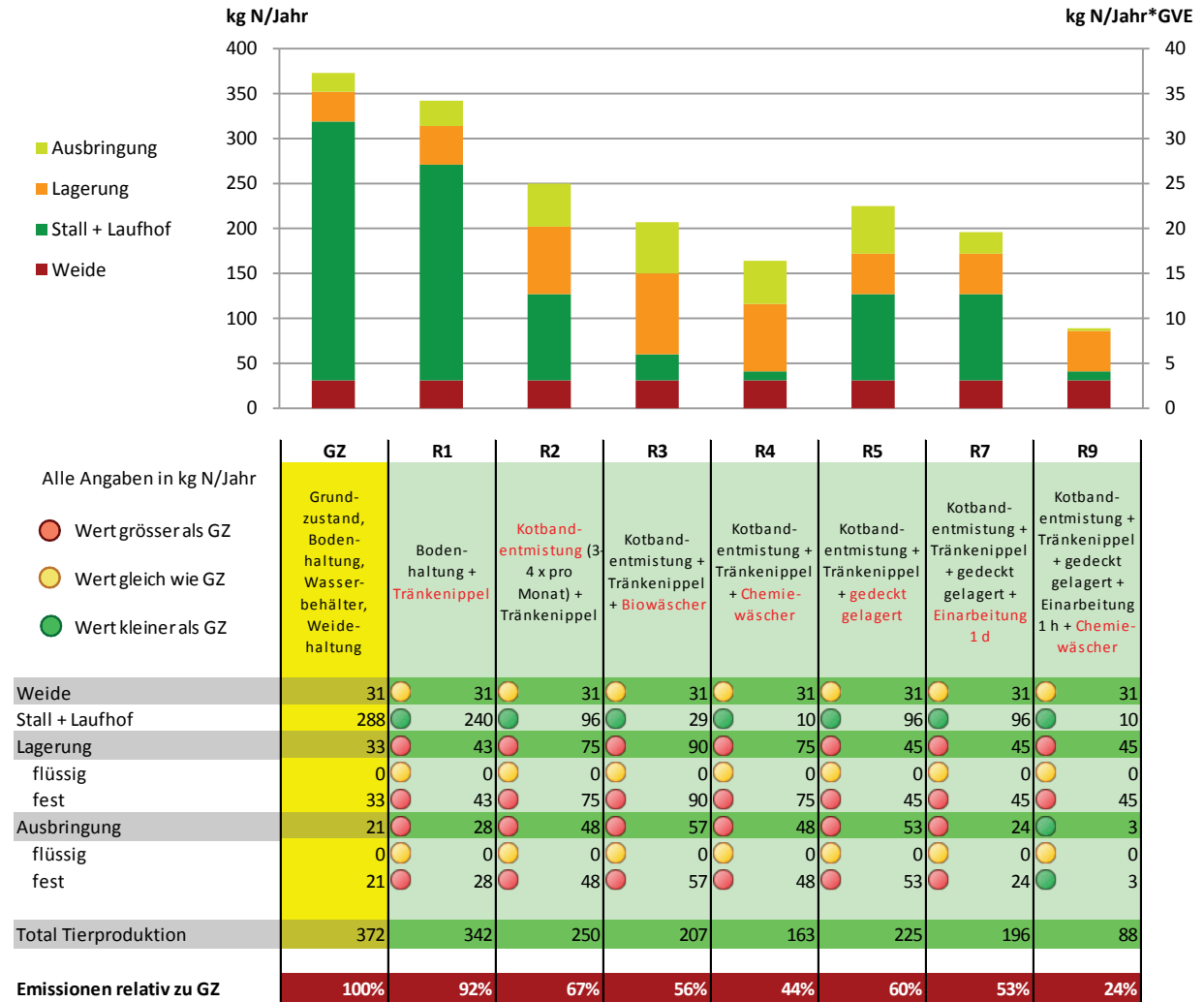
Abbildung 51: Resultate der Berechnungen für den Beispiel-Betrieb E4, berechnet mit dem kantonal angepassten Modell von Agrammon. GZ = Grundzustand, R = Reduktionsmassnahmen, V = Vergleichsszenarien.
