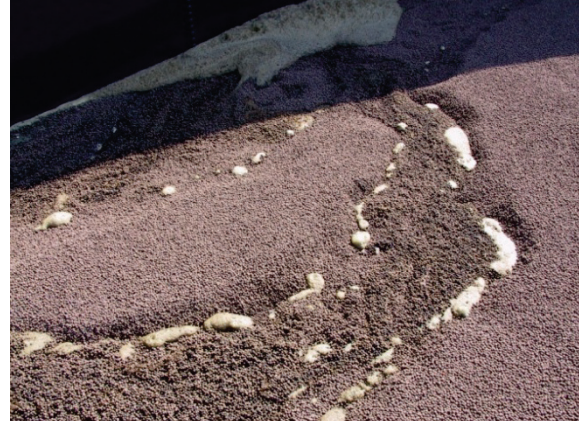
Abbildung 17: Blähtonkugel-Schwimmschicht (Dux, Van Caenegem, Steiner, & Kaufmann, 2005)
