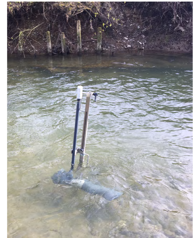
Abbildung 5: A) Fest installierter, automatischer Probenehmer, wie er an den NAWA-Standorten (Beggingerbach, Zwärenbach, Landgraben) verwendet wurde. B) Passiver Wassersammler, der in der Biber installiert war.
