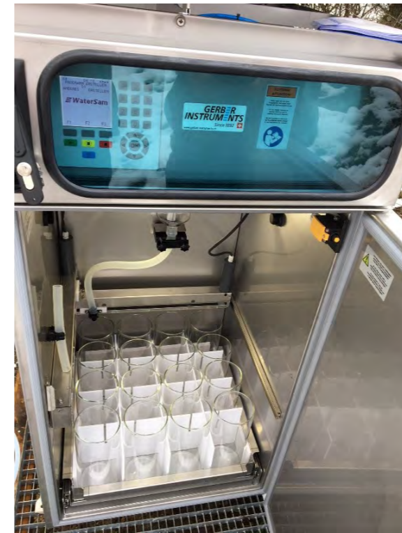
Abbildung 5: A) Fest installierter, automatischer Probenehmer, wie er an den NAWA-Standorten (Beggingerbach, Zwärenbach, Landgraben) verwendet wurde. B) Passiver Wassersammler, der in der Biber installiert war.
