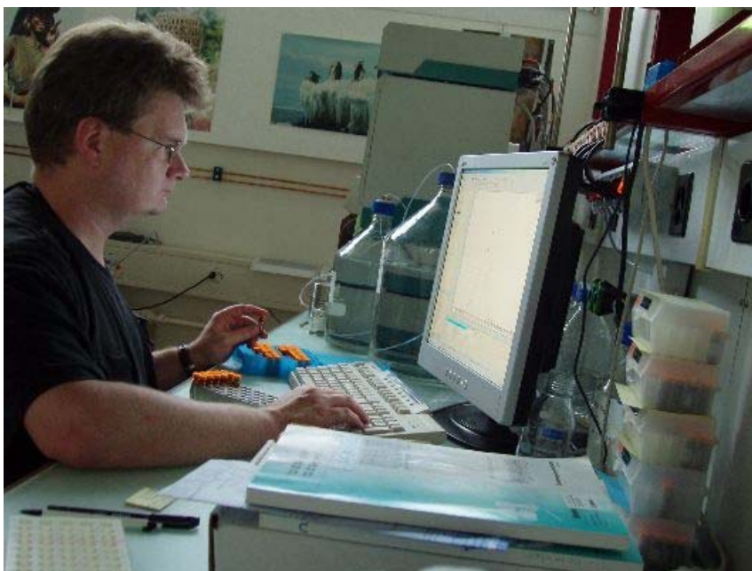
Bild 6: U. Burkhardt bei der Nitratanalyse am Ionenchromatograph
