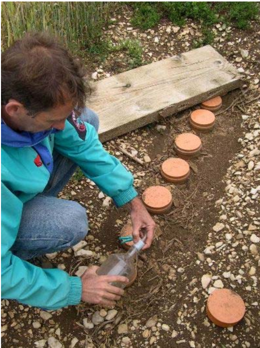
Bild 5: H.U. Dierauer bei der Probenahme (Saugkerzenstation mit 8 Flaschen)
