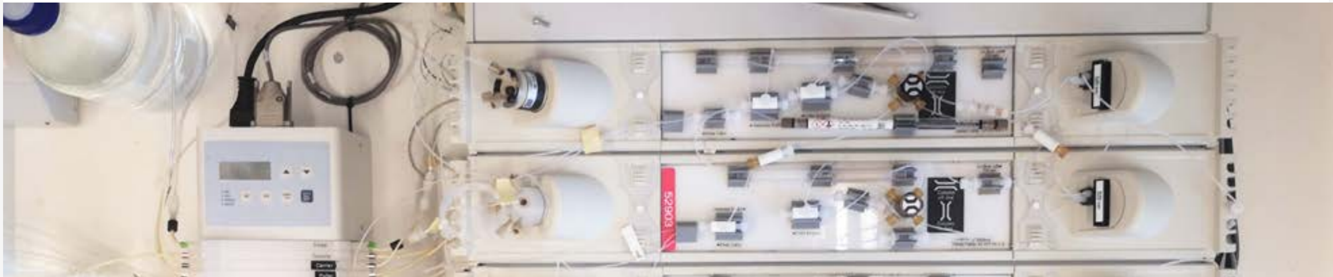
Fliessinjektionsanalyse zur Stickstoff- und Phosphormessung am Interkantonalen Labor
