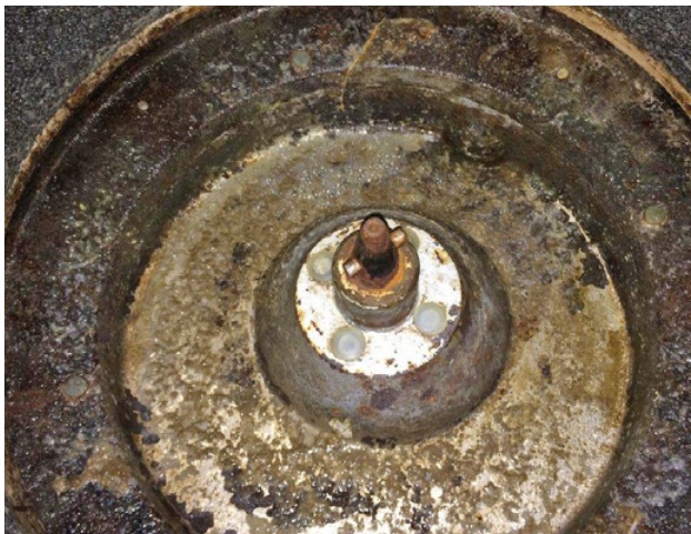
Die Kartoffelschälmaschine ist ein rotierender, rauer Schleifteller, der mit viel Wasser die Kartoffelschalen abschleift. Wenn man das Gerät nicht richtig reinigt, bilden sich stinkende Schmutzfilme unter dem rotierenden Schleifteller. Fotos: L. Kuhn
