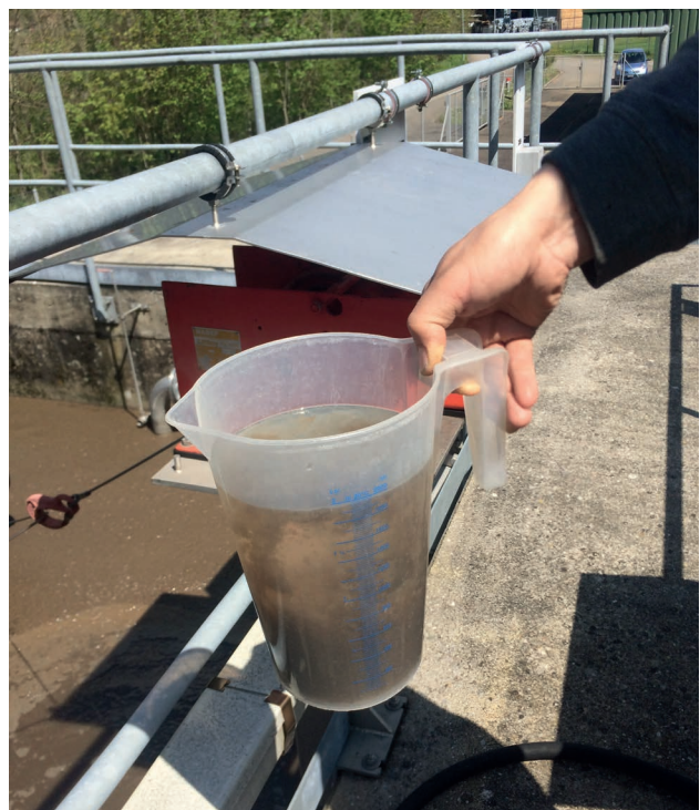
Mit Chlor vergifteter Belebtschlamm. Foto: R. Bombardi
