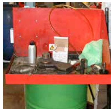
Kleinteilereiniger: Klappdeckel, die bei Nichtbetrieb geschlossen werden.
